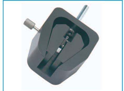
**En option, mâchoire auto-serrante :** La mâchoire auto-serrante peut remplacer le simple excentrique si nécessaire. Elle permet de maintenir les câbles et les fils lors des essais de traction. Conçue pour augmenter le serrage au fur et à mesure que la force de traction augmente, elle permet d'éviter le glissement de l'échantillon.
