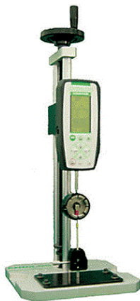
Wiretest I y TI - Verificación manual sencilla de cables y terminales
