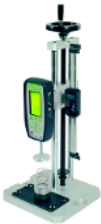
Springtest I y TI - Mediciones simples de los muelles de torsión y compresión
