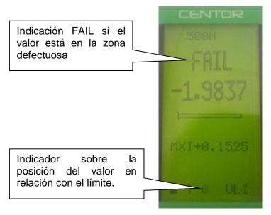
Esta función también activa automáticamente una salida digital del dinamómetro en el conector de 15 pines situado en el lateral del v. Esta salida se configura en el menú ENT/SALID. Por ejemplo, permite enviar una señal a un bastidor motorizado para detenerla en una fuerza determinada.
