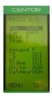
La primera parte de la pantalla corresponde a los parámetros de transmisión RS232 y puede modificarse mediante las teclas ZERO y TDX. Deben ser idénticos a los del ordenador al que está conectado el Centor Easy.
