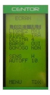
Salga de esta pantalla pulsando el botón M para guardar sus ajustes. Este menú le permite configurar completamente su pantalla.
