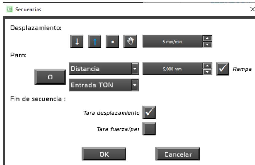
**DESPLAZAMIENTO** Hacia arriba (dirección ascendente) o hacia abajo (dirección descendente). La casilla le permite hacer una secuencia sin moverse. En este caso, la velocidad será cero y la condición de parada será obligatoria con el tiempo.
