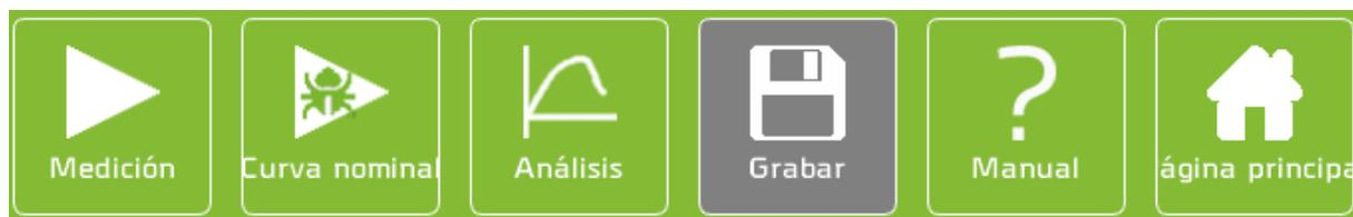
**MEDICIÓN** Permite el acceso directo a la ventana de medición. Anteriormente se guarda la configuración.
