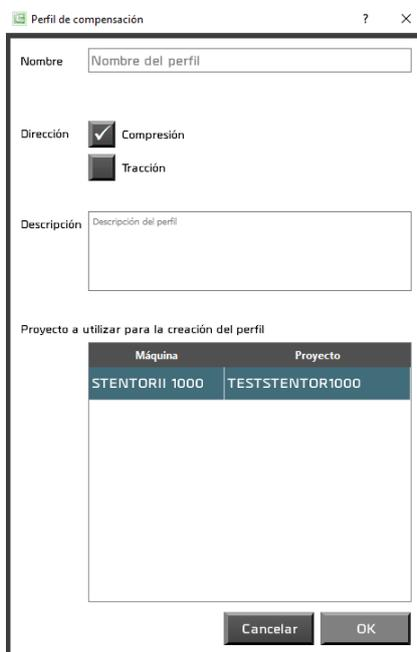
En primer lugar, introduzca el nombre de su perfil de compensación y elija compresión o tensión según su prueba. A continuación, seleccione el proyecto que desea compensar de la lista. Su perfil de compensación no estará permanentemente asociado con esta prueba, también puede ser utilizado en otras pruebas. Pulse Aceptar.
