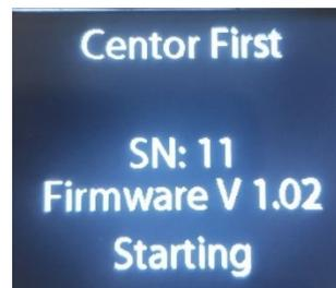
Wenn das Gerät nach dem Selbsttest funktioniert, zeigt das Kraftmessgerät den Messbildschirm an. Es zeigt dann 0 N an. Beim Start des Geräts wird eine Tara durchgeführt.
