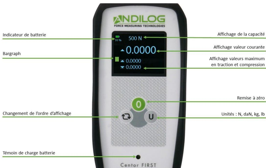
**Indicateur de batterie :** varie entre 0% et 100% pour indiquer l'autonomie de la batterie. Quand la batterie est neuve l'autonomie est de 15h environ en utilisation continue. Quand le pourcentage de batterie atteint 0% le dynamomètre s'éteint.
