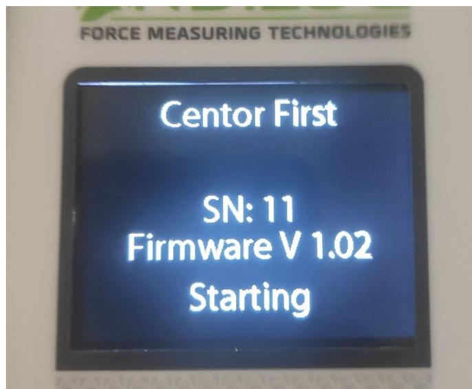
Après l'autotest, si l'appareil est fonctionnel, le dynamomètre affiche l'écran de mesure. Il affiche alors 0 N. Une tare est effectuée au démarrage de l'appareil.
