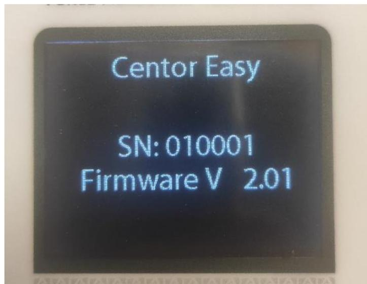
Wenn das Gerät nach dem Selbsttest funktioniert, zeigt das Kraftmessgerät den Messbildschirm an. Es zeigt dann 0 N an. Beim Start des Geräts wird eine Tara durchgeführt.
