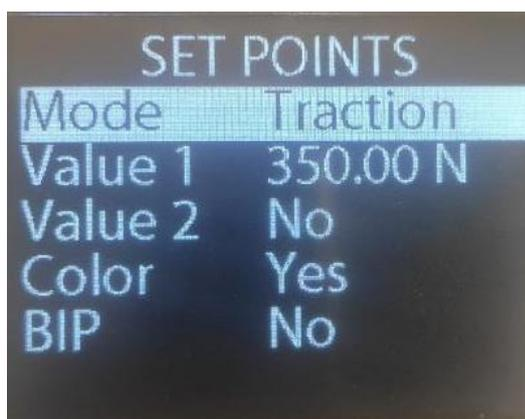
In diesem Menü können Sie Schwellenwerte für den Kraftmesser einstellen. Es ist möglich, einen Ton zu erzeugen, wenn man seine Schwellenwerte überschreitet, und die Farbe der Messwertanzeige entsprechend den Schwellenwerten ändern zu lassen.
