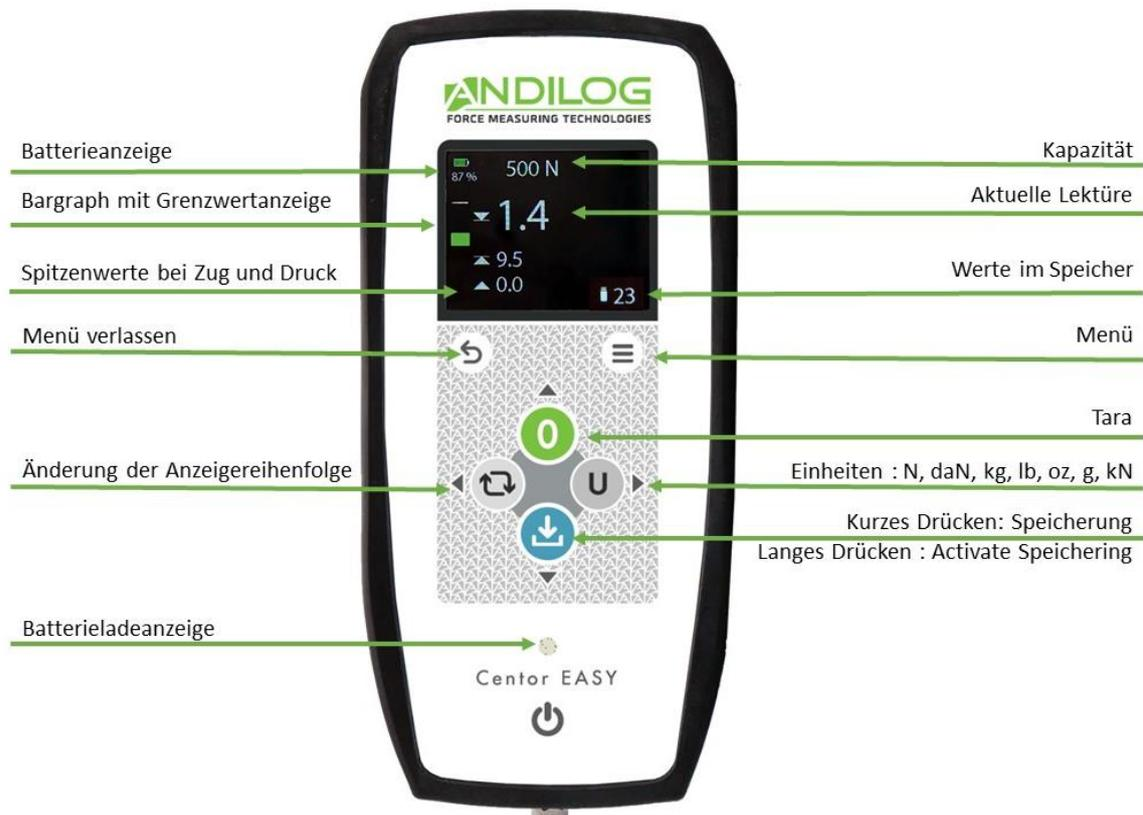
**Batterieanzeige:** Variiert zwischen 0% und 100%, um die Akkulaufzeit anzuzeigen. Wenn die Batterie neu ist, beträgt die Laufzeit bei Dauerbetrieb etwa 15 Stunden. Wenn der Batterieprozentsatz 0% erreicht, schaltet sich der Kraftmesser aus.
