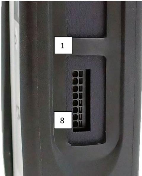
Connexion électrique : le connecteur avec les E/S se situent sur le côté du Centor. Il y a 8 broches disponibles :
