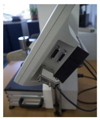
Le connecteur du capteur vient se brancher sur le côté du contrôleur dans le connecteur 9 points prévus à cet effet.
