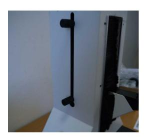
La course de la traverse peut être limitée grâces à des butées mécaniques supérieures et inferieures. Les butées mécaniques évitent d'endommager le capteur et accessoires de préhension. Si la traverse atteint une butée lors d'un essai, elle s'arrêtera. Les butées doivent être ajustées après fixation des accessoires de façons à ce que les positions de butée empêchent le contact de la partie mobil sur la partie fixe.
