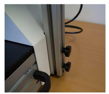
Fixez le pied au moyen des deux vis moletées sur le côté droit du bâti. Des écrous sont situés dans les rainures de la base du bâti.
