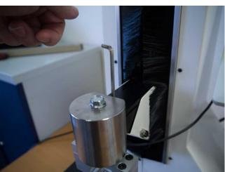
Serrage du support sur la traverse au moyen d'une clé 6 pans. Le support ne doit plus avoir de jeu après serrage.
